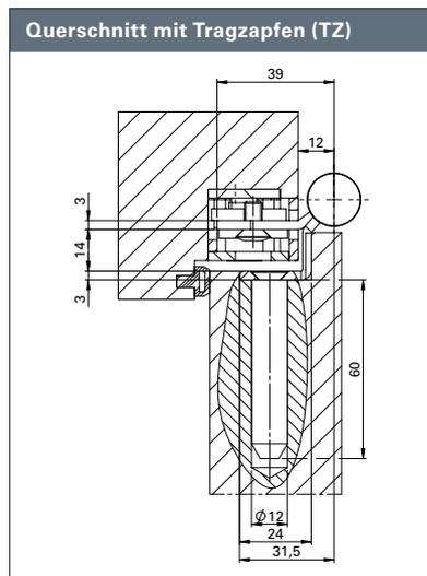
A: Nur bei Ausführung mit Tragzapfen. ■ Aufnahmeelement 3D Serie OBX ist separat zu bestellen. Tragzapfen/Schrauben sind separat zu bestellen.
