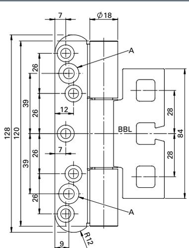
**Querschnitt mit Tragzapfen (TZ)**
