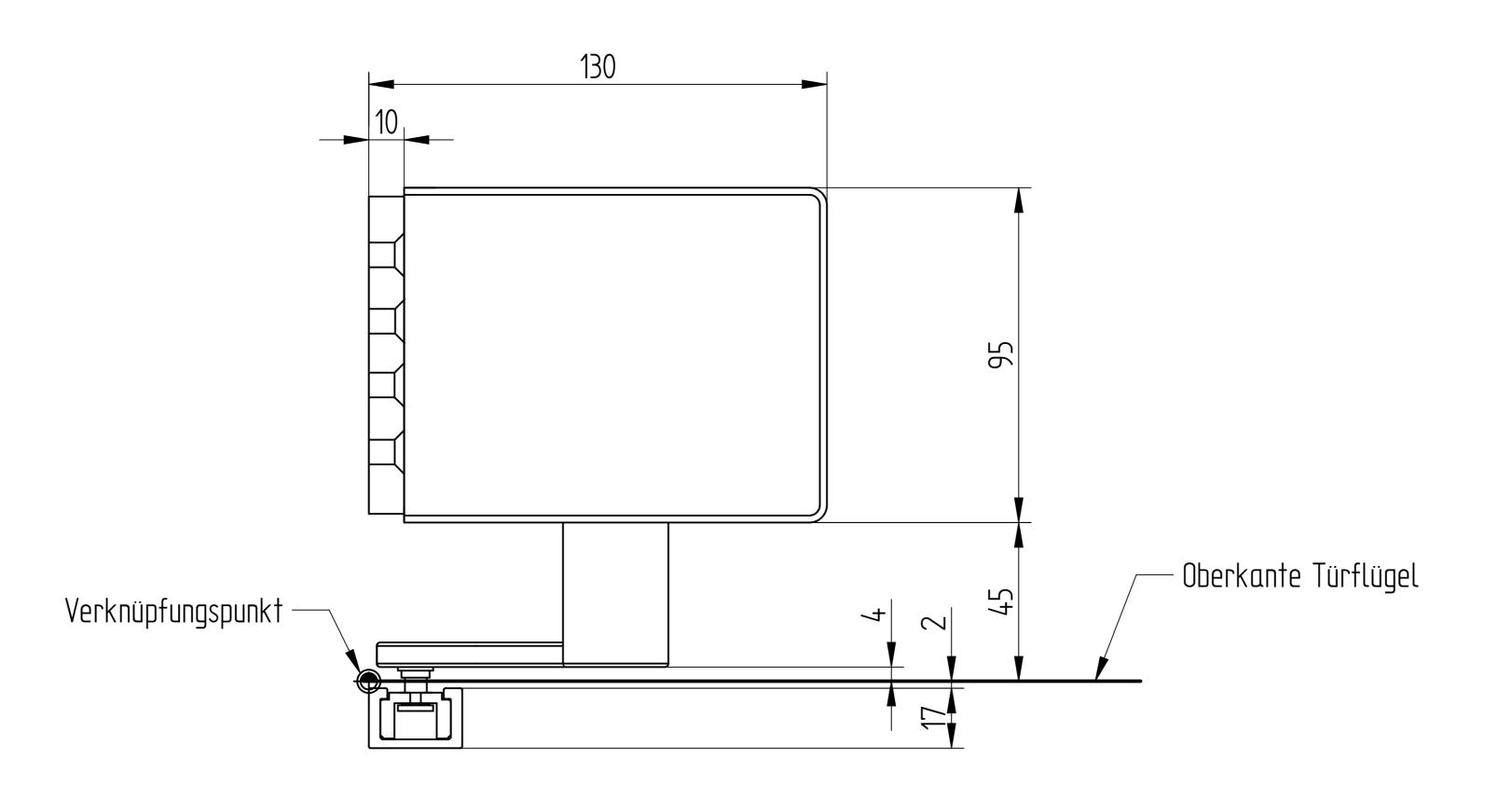
Bohrbild für Montageplatte und Gleitschiene
